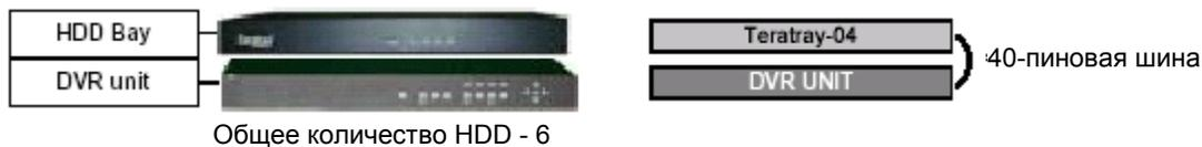
ЦВР (с 2-мя установленными HDD) и HDD Bay (содержащего 4 HDD), итого общее количество HDD - 6.
