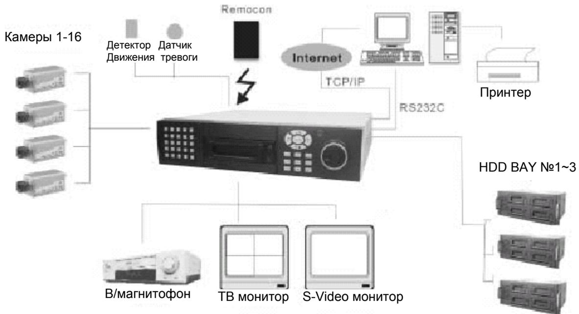
Замечание: RS-232C предназначен для R&D тестирования и не имеет пользовательского назначения
